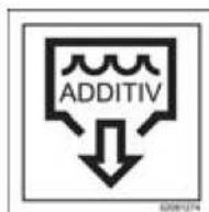
Vaciado de depósito de agua de rociado aditivo
