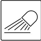
Interruptor basculante de tres posiciones. Las funciones del interruptor están activas cuando el interruptor de encendido está en la posición ON. Las luces de trabajo funcionan independientemente del circuito de luces principal. No conduzca en carretera con las luces de trabajo encendidas. Puede entorpecer la visibilidad de otros conductores y causar un accidente. En las máquinas para Italia y Alemania, no se pueden tener encendidos al mismo tiempo los faros y las luces de trabajo delanteras.
