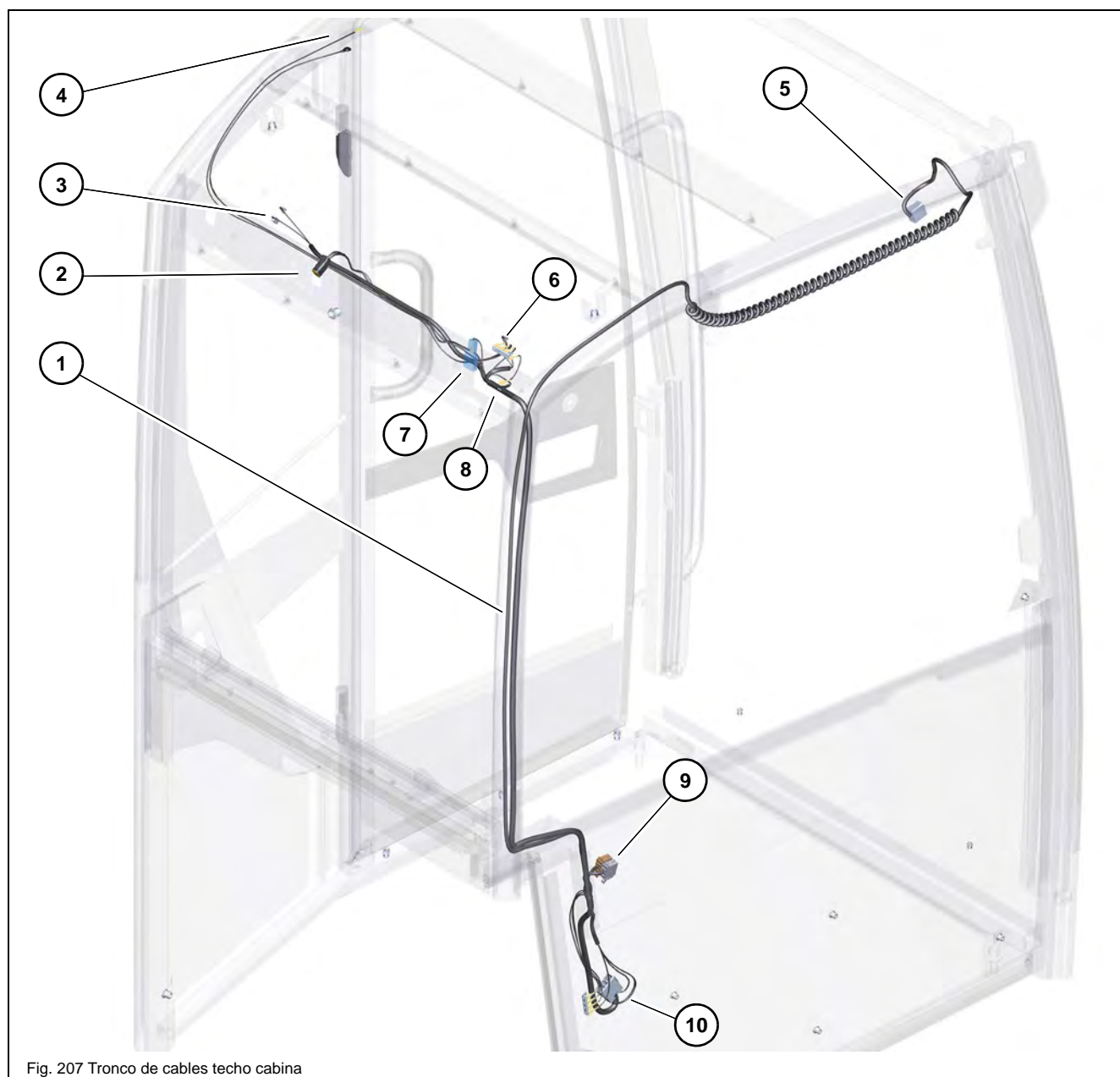
Fig. 207 Tronco de cables techo cabina
