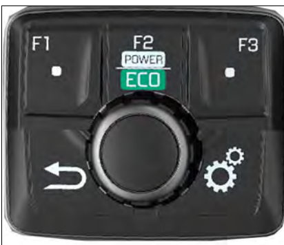
Fig. 178 Aparato de mando N023 - HMI Interfaz hombre-máquina (disco selector)
