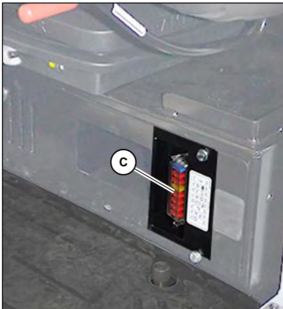
Fig. 31 Asignación de la caja de fusibles de la cabina
