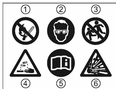
Fig. 48 Indicaciones de la pegatina de advertencia de la batería
