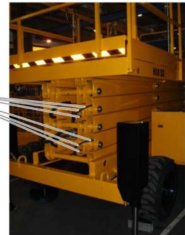
LE CABLE D'ALIMENTATION DOIT SUIVRE LE FAISCEAU PUPITRE THE POWER CABLE HAS TO FOLLOW THE BEAM WRITING DESK
