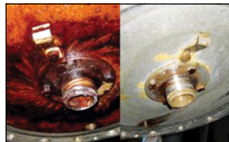
Cubierta del depósito contaminado limpio
