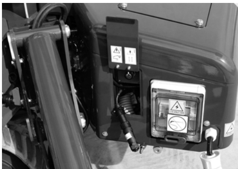
Fig. 154 Posición conector según telemando opcional
