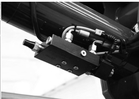
Fig. 12 Válvula de bloqueo de los cilindros brazos
