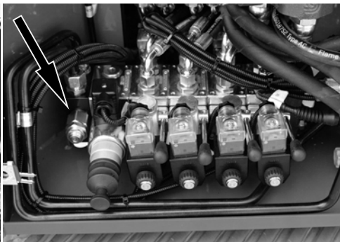
Fig. 10 Válvula de sobrepresión carro
