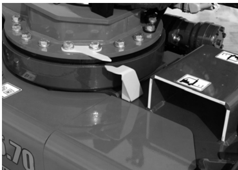
Fig. 91 Flechas control alineación
