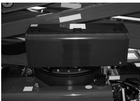
Fig. 124 Cáster distribuidor parte aérea
