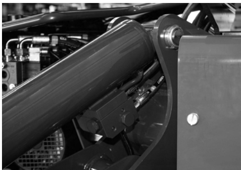
Fig. 11 Válvula de bloqueo estabilizadores
