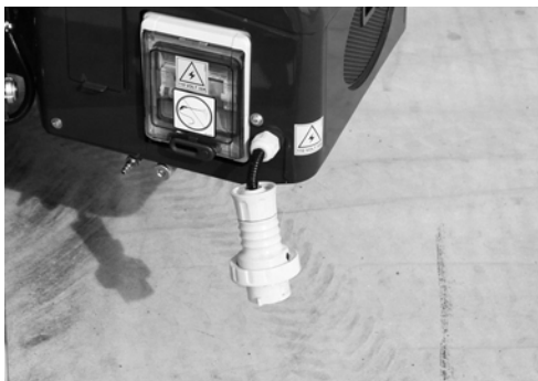
Fig. 145 Toma red eléctrica
