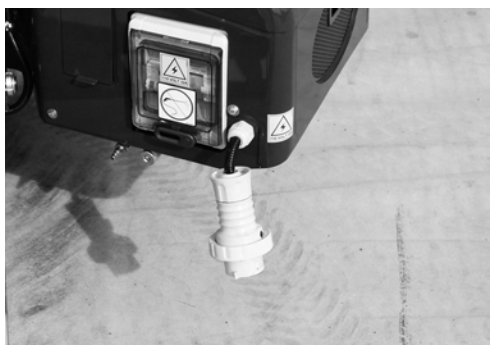
Fig. 82 Toma red eléctrica
