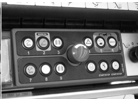
Fig. 62 Pulsador de parada de emergencia en el telemando
