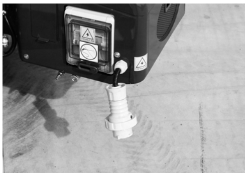
Fig. 147 Toma red eléctrica
