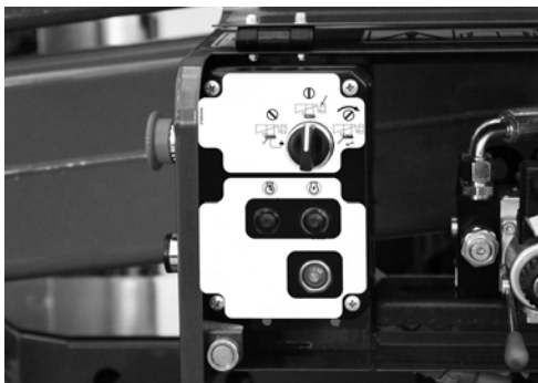
Fig. 113 Panel mandos de emergencia selector y pulsadores
