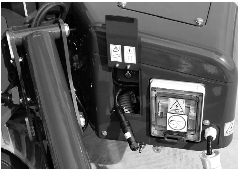
Fig. 59 Posición conector según telemando opcional
