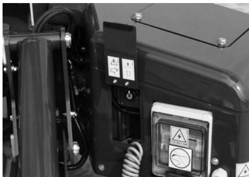
Fig. 132 Caja eléctrica interna en el compartimiento de los componentes eléctricos.
