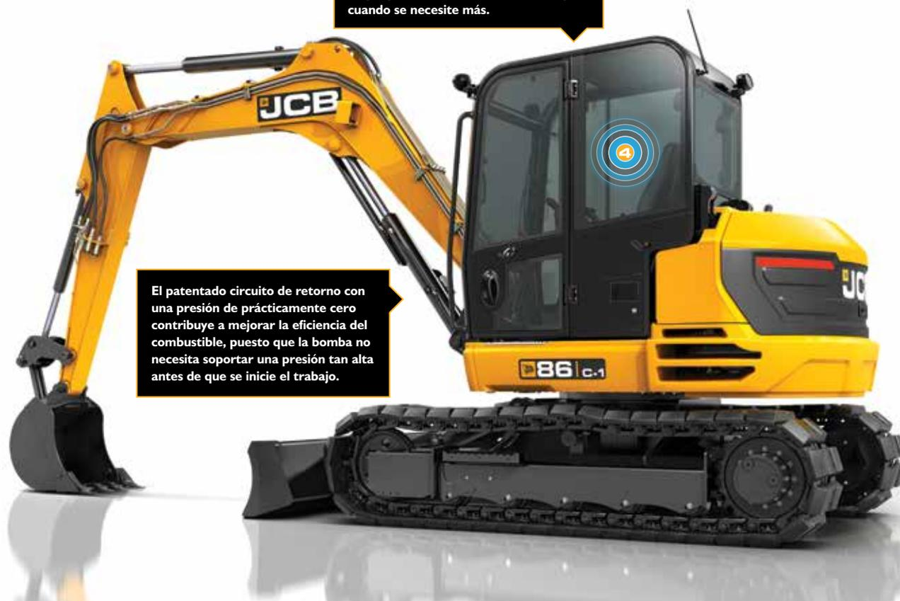
El patentado circuito de retorno con una presión de prácticamente cero contribuye a mejorar la eficiencia del combustible, puesto que la bomba no necesita soportar una presión tan alta antes de que se inicie el trabajo.
