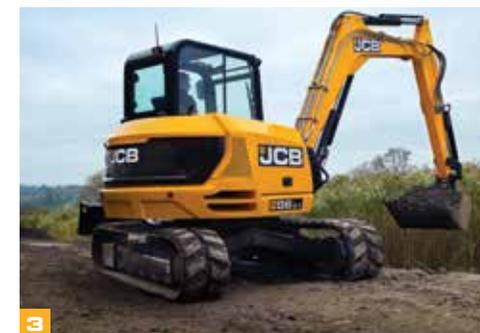
La protección del cilindro de la pluma para trabajos pesados ofrece una protección óptima con protecciones opcionales para el cilindro de carga y el balancín, útiles en el caso de las aplicaciones más exigentes.
