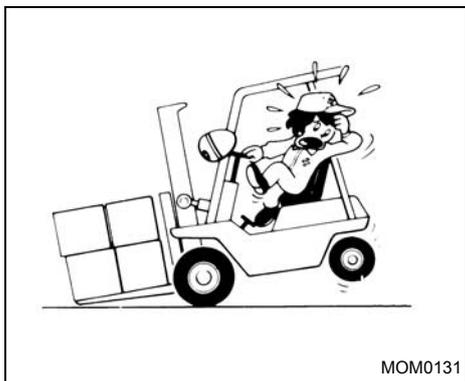
**⚠** Não sobrecarregue a empilhadora. Verifique a tabela de carga para obter informações sobre o peso e o centro da carga. Efectue sempre o levantamento de cargas tão próximo do centro do peso quanto possível para evitar um carregamento descentrado.
