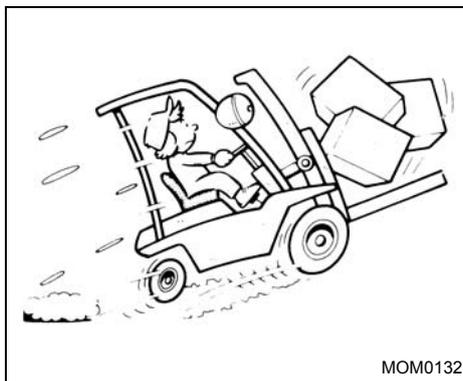
**⚠** Evite arranques, paragens e mudanças de direcção bruscas. Abrace para mudar de direcção e em superfícies desniveladas ou escorregadias que possam provocar o capotamento ou o deslizamento da empilhadora.
