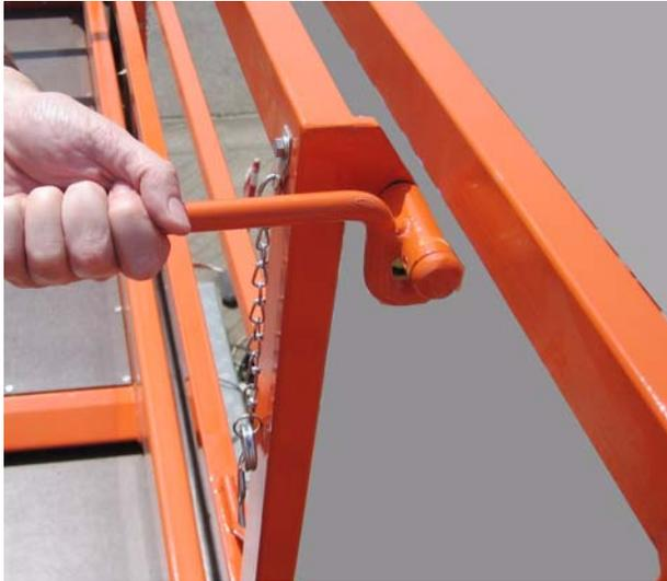
3. Después de haber elevado las manijas, empujar la extensión de la plataforma de modo uniforme hasta que quede completamente extendida.
