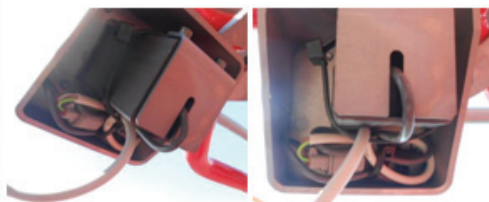
Connecteur (CN05) placé dans boîtier support (esthétique et protection)
