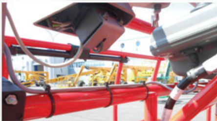
Connecteur (CN05) placé dans boîtier support (esthétique et protection)
