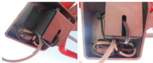
Connecteur (CN06) placé dans boîtier support (esthétique et protection)
