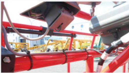
Connecteur (CN05) placé dans boîtier support (esthétique et protection)
