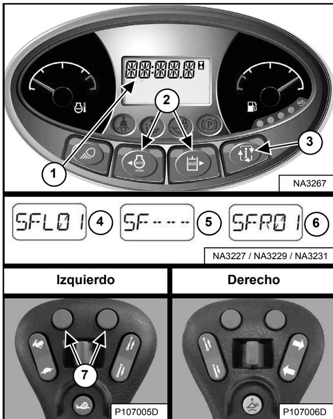
Pulse el botón de información (3) para desplazarse por la pantalla de datos hasta que se muestre el menú de compensación de la desviación de la dirección. La configuración actual de la compensación de la desviación de la dirección aparecerá en la pantalla de datos (1) [Figura 68].
