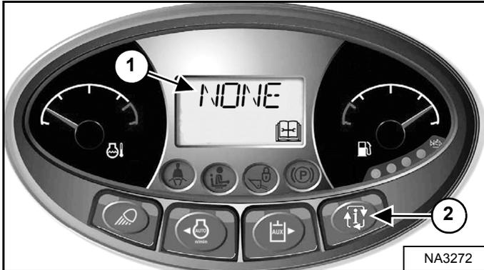
Pulse el botón de información (2) para desplazarse por la pantalla de datos (1) [Figura 292] hasta que aparezcan los códigos de mantenimiento. Si hay más de un código de mantenimiento, los códigos aparecerán en la pantalla de datos.
