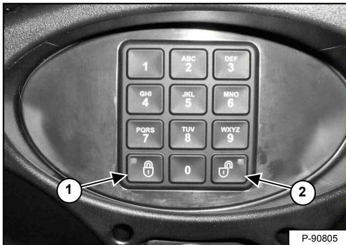
Mantenga pulsadas las teclas de bloqueo (1) y desbloqueo (2) [Figura 295] durante 2 segundos.
