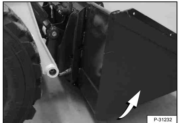
Incline el Bob-Tach hacia atrás hasta que el borde de ataque del cucharón (u otro implemento) esté ligeramente por encima del suelo [Figura 141]. Esto hará que el bastidor de montaje del cucharón se apoye en la parte delantera del Bob-Tach.
