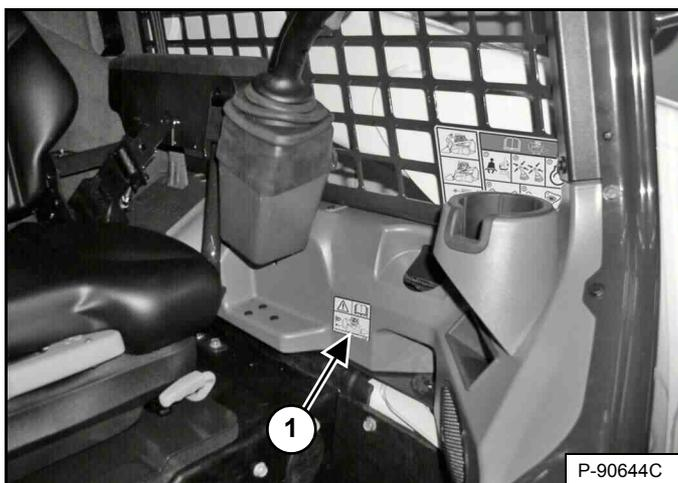
Compruebe si la pegatina de la alarma de marcha atrás (1) [Figura 167] está dañada o si falta. Sustituya si fuese necesario.
