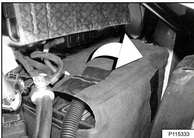
Abra la solapa superior de la caja de la batería para acceder a los bornes [Figura 228].
