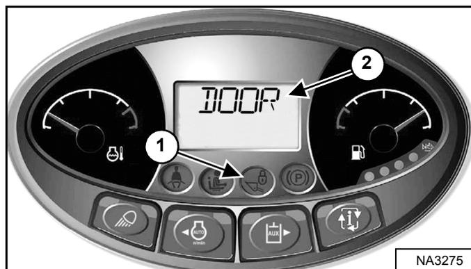
La luz de la VÁLVULA DE ELEVACIÓN E INCLINACIÓN (1) [Figura 172] se APAGA cuando se cierra la puerta, se gira la llave de contacto a la posición RUN, se baja la barra de seguridad y se pulsa el botón PULSAR PARA ACTIVAR LA CARGADORA.
