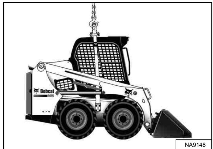
Coloque un cable o cadena en el ojal de elevación [Figura 151].
