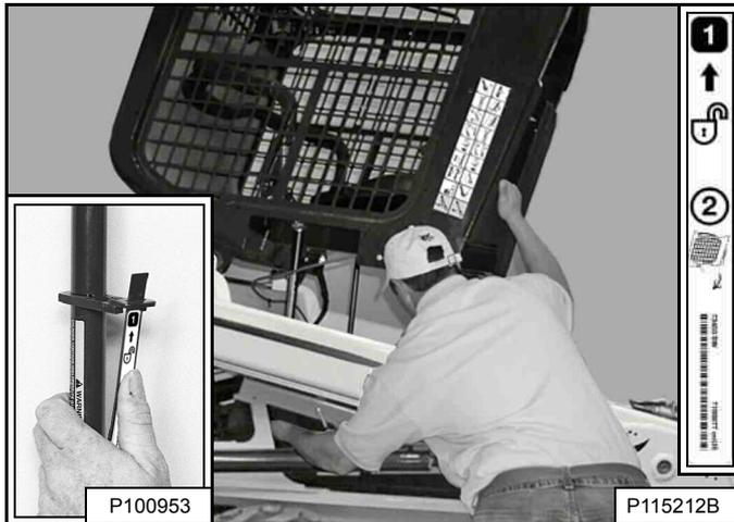
Tire hacia abajo de la parte inferior de la cabina del operador hasta que se detenga en el mecanismo de cierre [Figura 176].
