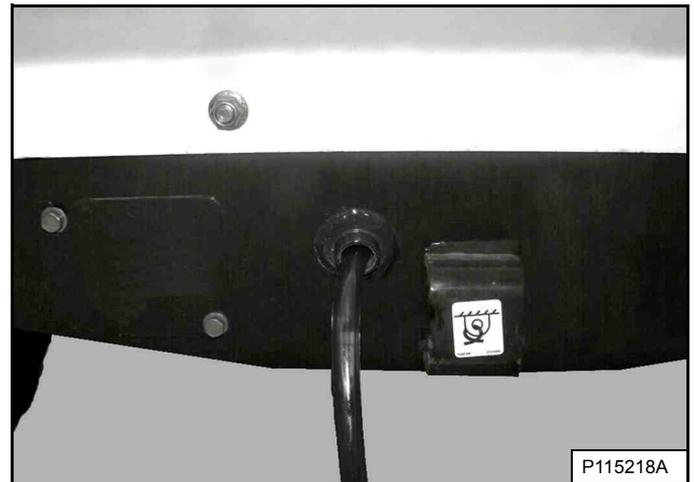
Vacíe el fluido del cárter de cadena [Figura 261]. (Los brazos de elevación se muestran levantados para que resulte más claro.)
