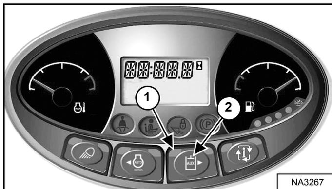
Pulse una vez el botón del sistema hidráulico auxiliar (2) [Figura 83] para activarlo.
