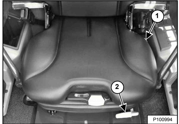
Tire de la palanca (1) [Figura 105] hacia arriba para regular el ángulo del respaldo del asiento.
