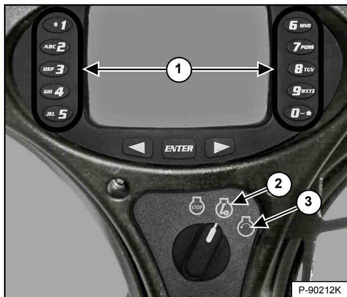
Gire la llave de contacto a la posición RUN (2) [Figura 122]. Las luces indicadoras del panel de instrumentos izquierdo se ENCENDERÁN brevemente y el panel de instrumentos / sistema de monitorización realizará una autocomprobación.
