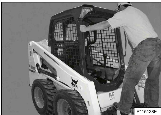
Utilice los peldaños del cucharón o del implemento, las agarraderas y las huellas antideslizantes (en los brazos de elevación y el bastidor de la cargadora) para entrar y salir de la cargadora; mantenga siempre 3 puntos de contacto [Figura 101]. No salte.
