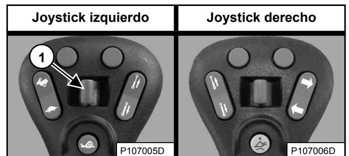
Mueva el interruptor del sistema hidráulico auxiliar trasero (1) [Figura 94] o [Figura 95] a izquierda y derecha varias veces. Gire la llave de contacto a la posición de PARADA.
