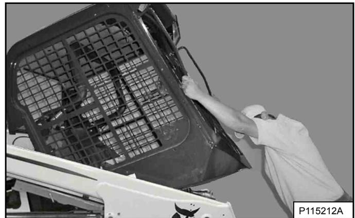
Suba la cabina del operador lentamente por medio de las agarraderas y tomándola del borde inferior [Figura 175] hasta que esté completamente levantada y el mecanismo de cierre se active.
