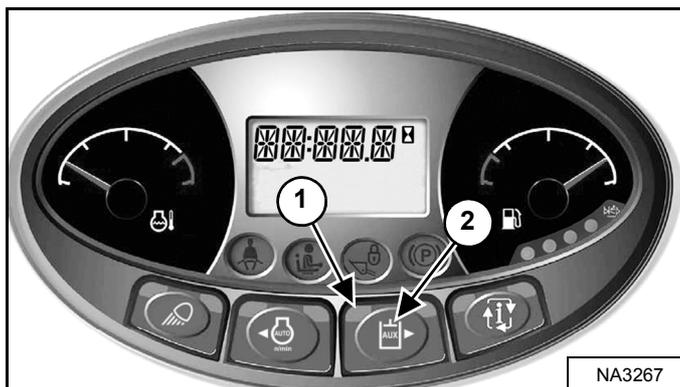
Pulse una vez el botón del sistema hidráulico auxiliar (2) [Figura 88] para activarlo.
