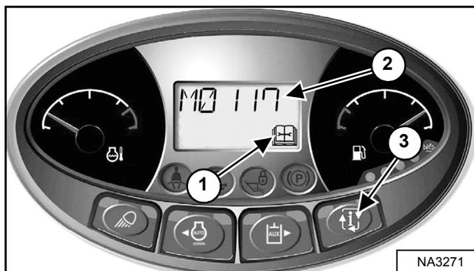
Sustituya los filtros de aire solamente cuando sea necesario. El indicador de servicio (1) PARPADEARÁ. Pulse el botón de información (3) hasta que la pantalla de visualización muestre los códigos de mantenimiento. Cuando sea necesario cambiar el filtro, el código de mantenimiento **[M0117]** (Filtro de aire obstruido) aparecerá en la pantalla de visualización (2) **[Figura 192]**.
