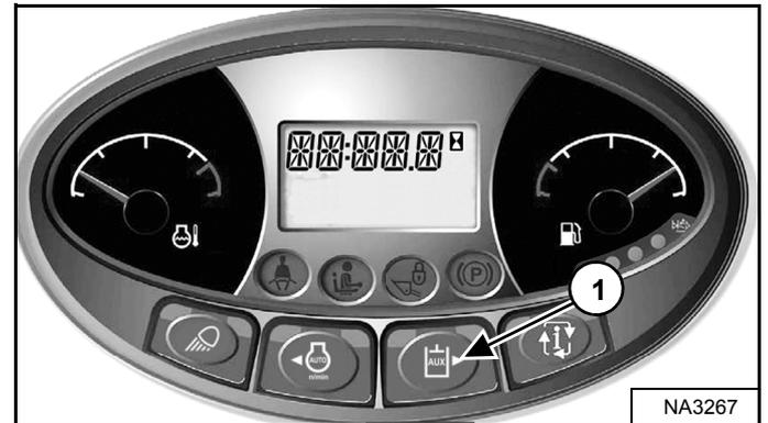
Pulse el botón del sistema hidráulico auxiliar (1) [Figura 93].
