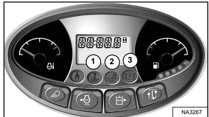
Hay tres luces indicadoras (1, 2 y 3) [Figura 31] en el panel de instrumentos izquierdo que deben estar APAGADAS para poder usar todas las funciones de la máquina.
