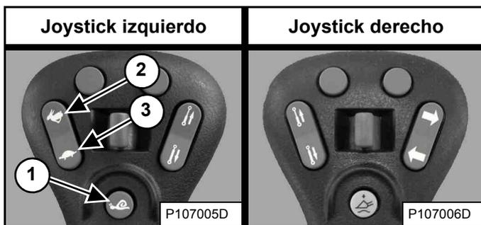
Para ajustar un porcentaje de velocidad mayor (2) o menor (3) [Figura 64], pulse el interruptor de control de la velocidad hasta que aparezca el valor que desee usar como predeterminado.
