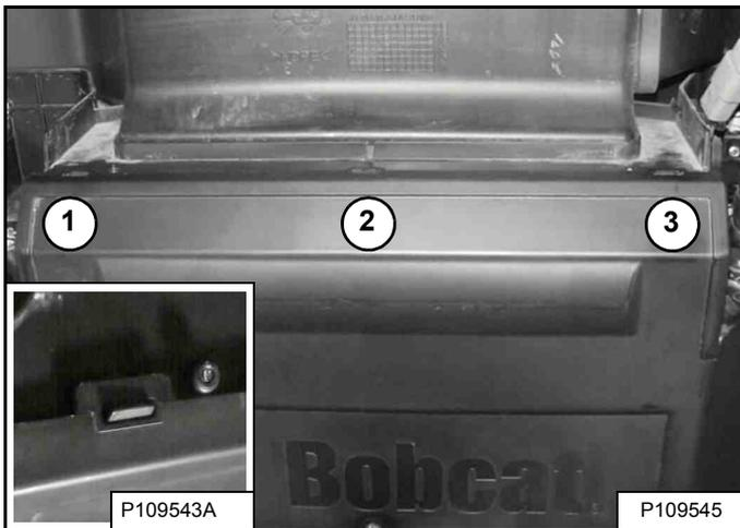
2. Empuje la tapa hacia arriba en tres puntos (1, 2 y 3) hasta que las ranuras encajen en su lugar en las pestañas. Esta ranura (inserto) [Figura 190] está fijada correctamente.
