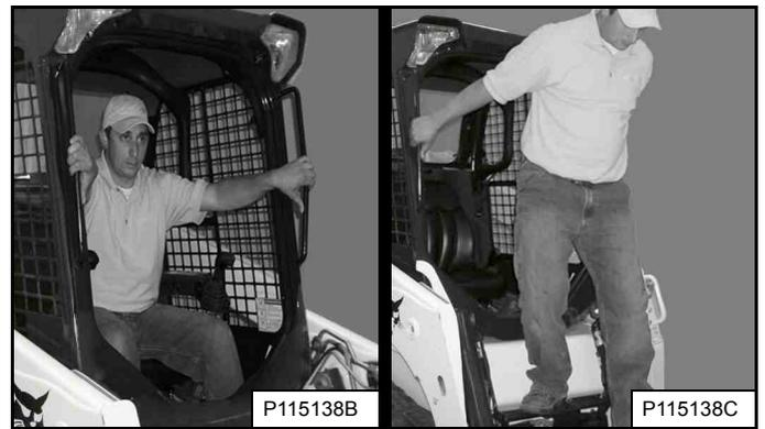
Salga de la cargadora utilizando las agarraderas, las huellas antideslizantes y los peldaños (mantenga siempre 3 puntos de contacto) [Figura 129].
