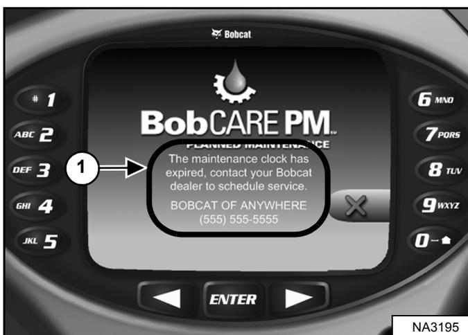
El tablero de instrumentos Deluxe (si viene equipado) mostrará un mensaje (1) [Figura 297] que avisará al operador de que debe realizar el mantenimiento de la máquina.
