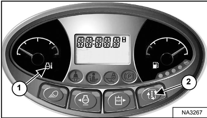
Vigile con frecuencia los indicadores de temperatura y combustible, así como las luces del BICS™ (todas deben estar APAGADAS para poder utilizar la cargadora) [Figura 126].
