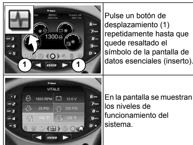
Pulse un botón de desplazamiento (1) repetidamente hasta que quede resaltado el símbolo de la pantalla de datos esenciales (inserto).
