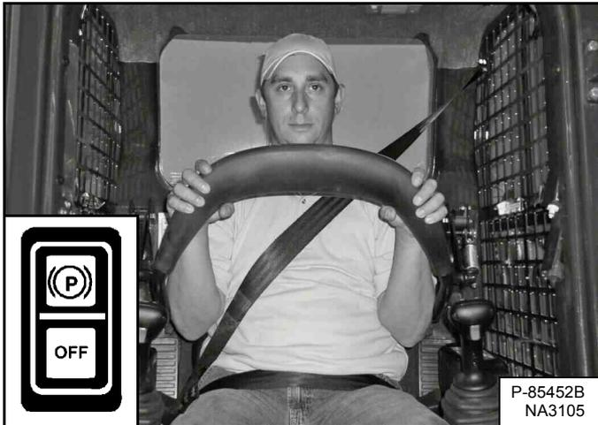
Baje la barra de seguridad y accione el freno de estacionamiento [Figura 109].
