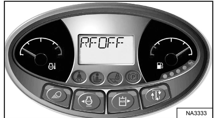
El ventilador reversible se desactiva cuando la temperatura del líquido hidráulico o del refrigerante del motor es demasiado alta o demasiado baja.
