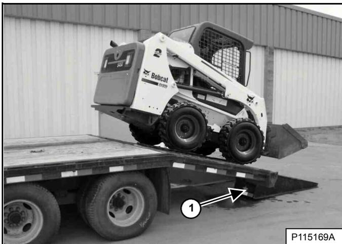
Cuando la cargadora tiene el cucharón vacío o no tiene ningún implemento, se debe subir marcha atrás en el vehículo de transporte [Figura 154].
