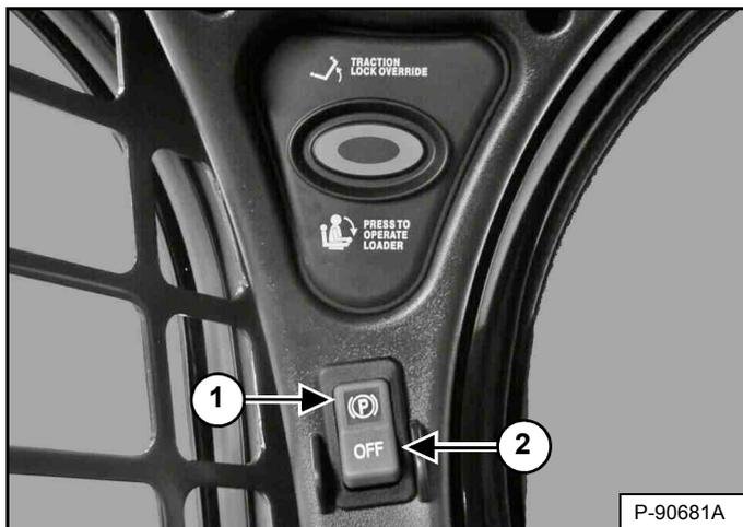
Pulse la parte superior del interruptor (1) [Figura 33] para activar el freno de estacionamiento. La luz roja del interruptor debe estar ENCENDIDA. El sistema de tracción se bloquea.
