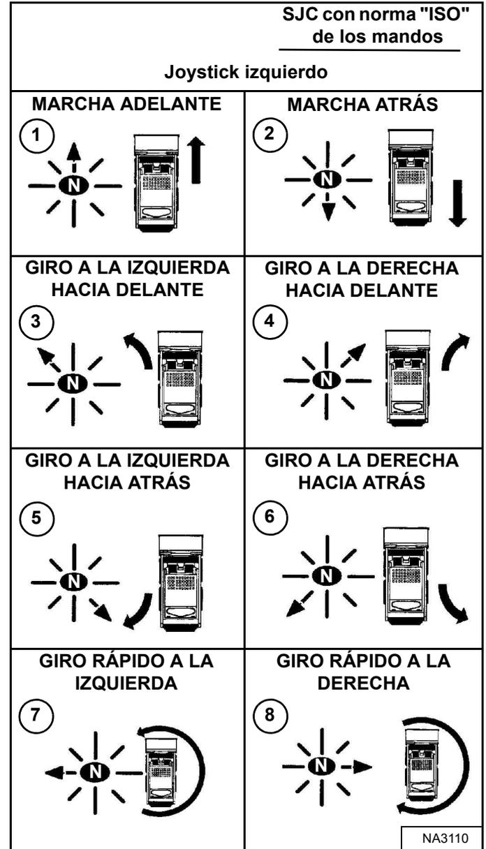
*Funciones del joystick izquierdo (tracción y dirección)* [Figura 56]:
