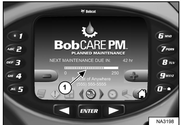
El tablero de instrumentos Deluxe (si viene equipado) mostrará una barra (1) [Figura 298] que indicará el tiempo que queda hasta el próximo mantenimiento. Esta barra se volverá roja cuando el mantenimiento haya vencido. **[PRÓXIMO MANTENIMIENTO PREVISTO EN]** pasará a ser **[MANTENIMIENTO PENDIENTE HACE]** y se mostrará la cantidad de horas que lleva pendiente.
