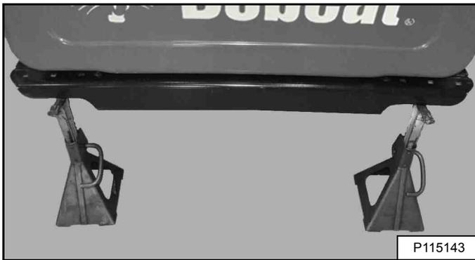
Coloque soportes mecánicos bajo la parte trasera del bastidor de la cargadora [Figura 173].
