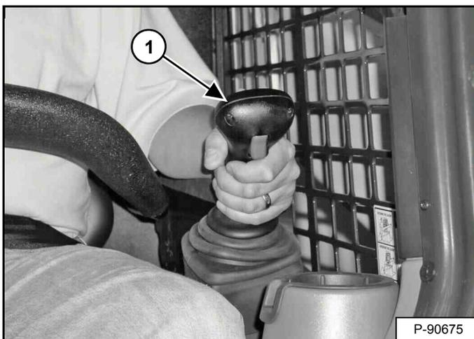
El joystick que controla la tracción y la dirección se encuentra en la parte izquierda, delante del asiento (1) [Figura 55].
