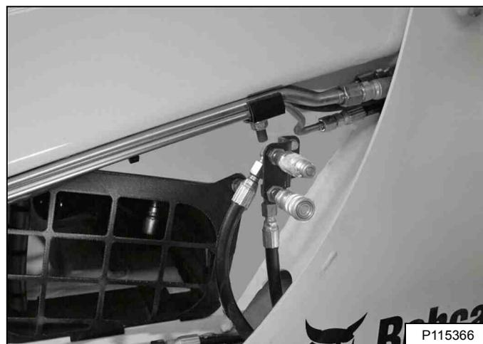
Mueva el interruptor del sistema hidráulico auxiliar trasero (1) [Figura 89] o [Figura 90] hacia la derecha o hacia la izquierda para cambiar la dirección del caudal de fluido hidráulico auxiliar a los acopladores rápidos traseros [Figura 91]. (Se muestra el lado izquierdo.) (EJEMPLO: Para subir y bajar los estabilizadores traseros.) Suelte el interruptor para detener el flujo del fluido.
