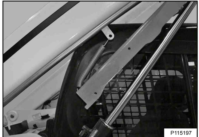
Levante ligeramente los brazos de elevación. El muelle levantará el seguro de los brazos y lo separará del vástago del cilindro de elevación [Figura 165]. Baje por completo los brazos de elevación.
