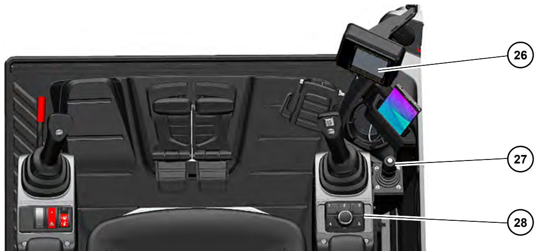
Fig. 105 Vista general de los controles de Tier IV
